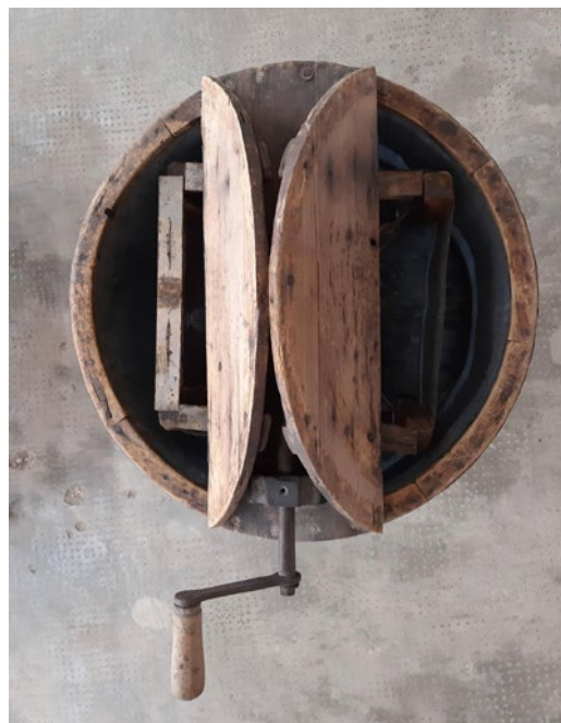
Fig. 11: Vista superior del extractor de miel. Se aprecia el mecanismo interior donde se colocan los panales para la extracción de la miel mediante su centrifugación. Foto: Jesús G. Guardiola.
